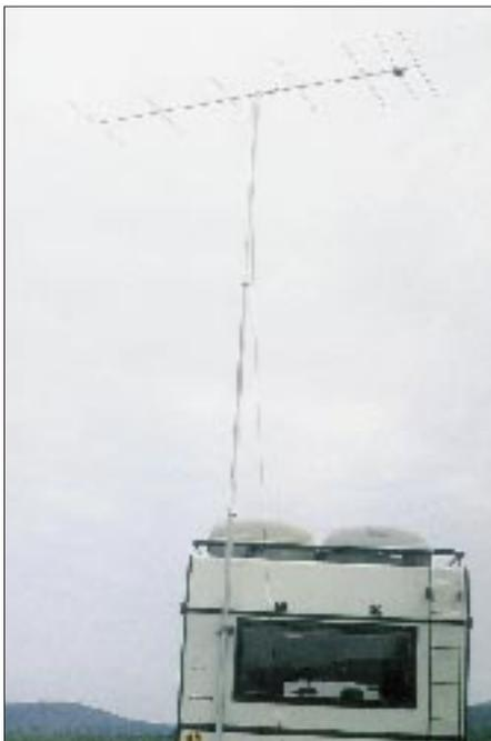
mit Plastispray überzogen werden, halten sie Jahre, bevor Korrosion einsetzt. Die Maße für Trägerrohre und Elemente müssen unbedingt eingehalten werden, um die propagierten Daten zu erhalten. Vorteil ist, daß bei exaktem Nachbau der beschriebenen Gammaanpassung und Einsatz des angegebenen Kondensators ein Abgleich entfällt und bei 144,3 MHz kein Rücklauf meßbar ist.
