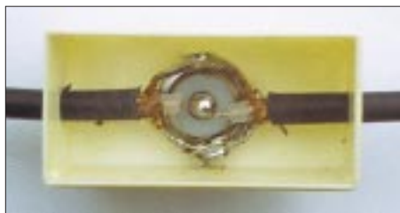
Bild 14: Anschlußdose für eine Zweiergruppe
