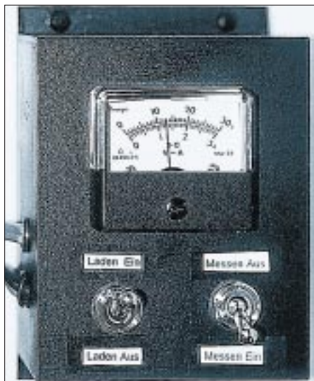
Bild 3: Ladebox mit Schaltern und Ampere-meter
