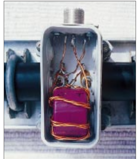
Bild 5: Anschlußdose mit Balun und Koaxialbuchse
