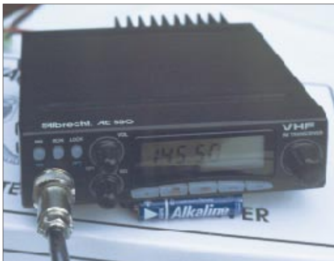
Das AE 550 ist ein relativ kleiner 2-m-Mobiltransceiver, der auf (überflüssige?) Schnörkel verzichtet, was sich auch auf der übersichtlichen Front äußert.
