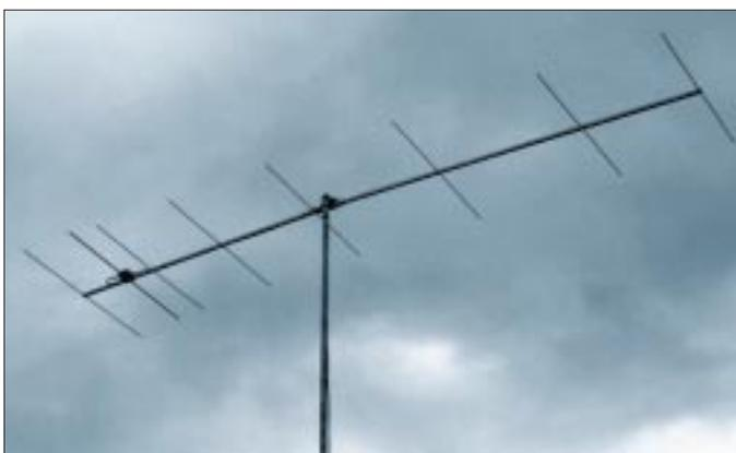
Bild 20: Die 8-Element-Yagi mit gestrecktem Dipol
